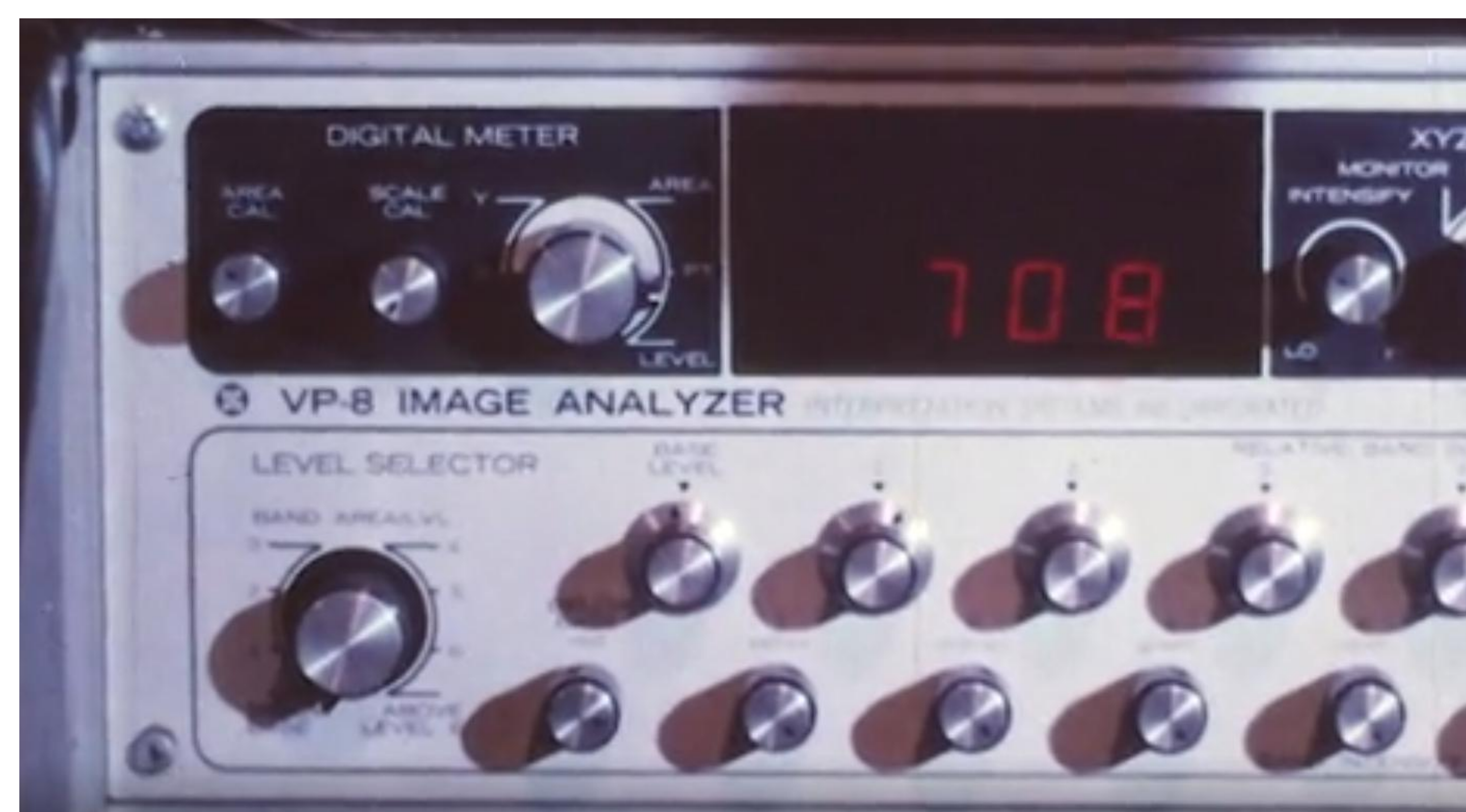
Figura 5: El analizador de imágenes VP-8
